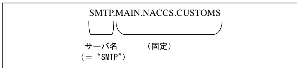
図 4-2-15 インタラクティブ処理方式 (SMTP 双方向) における センターサーバ側ドメイン名 (例) (半角大文字)
