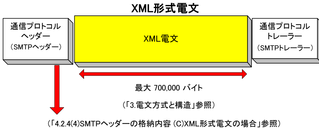
図 4-2-9 XML 形式電文の概要（インタラクティブ処理方式（SMTP 双方向））
